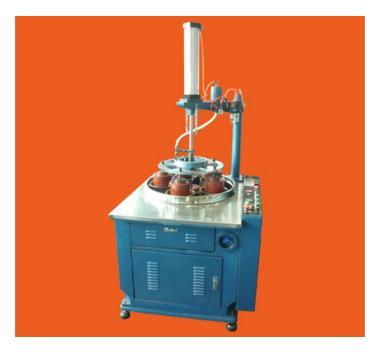
陶瓷平面研磨机在进行研磨抛光过程中冷却研磨盘的重要性:从事平面研磨的朋友都知道在超精密研磨抛光较薄脆零件过程中,研磨盘和工件是做相对摩擦运动的,研磨盘与工件的局部接触区域往往会出现高温,有时甚至可以达到几百度。局部的高温不但会烧伤零件表面,形成加工变质层,而且会引起零件的局部变形,同时,局部高温区的热量还会以热传导的方式传到整个研磨盘,使研磨盘也会发生热变形,研磨盘作为研磨加工的磨具,其面型精度能在一定程度上"复制"到工件表面。因此,陶瓷平面研磨机在进行研磨抛光过程中研磨盘自身的热变形对工件的面型精度一定会有影响。而且研磨盘温度越高,越不均匀,工件所受的变形影响越大。因此及时地将局部研磨盘高温区的热量驱散,合研磨盘各部分的温度比较均匀且处于较低的水平是非常的必要的。深圳特安达所研发的研磨盘冷却系统可以均匀快速的达到冷却效果,保证了研磨工艺的要求。
